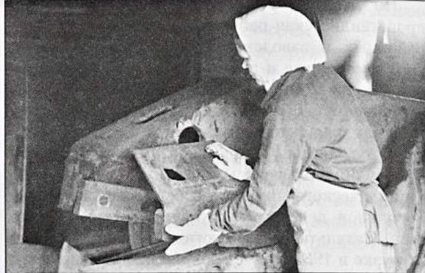
*Механическая рубка металлолома.
